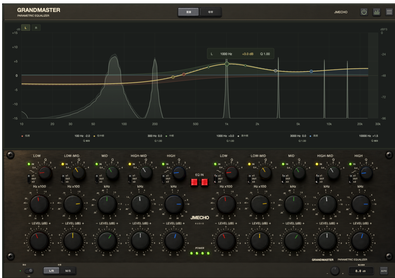
图 8. 实际六音测试 PCM 的原生截图：96 kHz 处理、48 kHz FFT 分析。输入为 80、200、1000、3200、9000、15000 Hz；Mixing EQ 设置为 100 Hz 低搁架 -2 dB、1 kHz Bell +3 dB / Q 1、10 kHz 高搁架 +1.5 dB。Trim 0 dB，AUTO、ADDA 与噪声关闭。截图使用计算测试信号。
