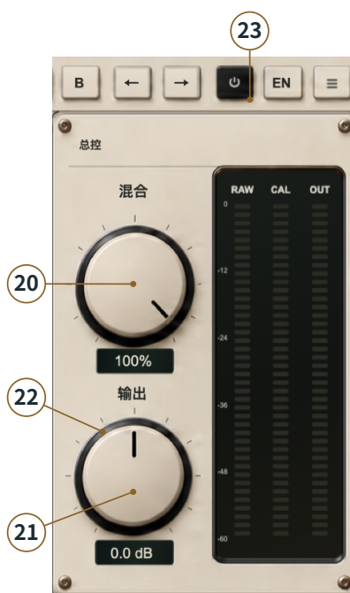
图 7. 总控区域 20-23。22 指向 OUTPUT 的 AUTO 悬停区域, 按钮在悬停或测量状态下出现; 23 位于顶栏。
