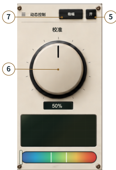
图 3. 动态区域 5-7。6 是全链输入校准，7 是模块后独立稳幅控制。
