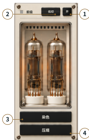
图 2. 前级控件 1-4。低切先于前级染色和压缩；图中开关均启用。
