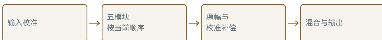
图 15. 简化信号关系；五模块内部仍有各自动态、滤波和补偿。内部输入平衡仅在动态模块启用时参与。
